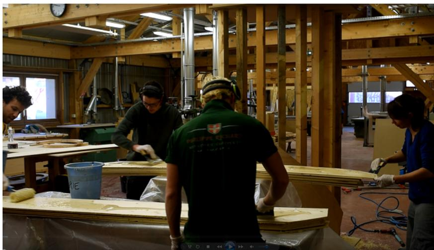
*Encollage d'un Lamellé Collé en atelier*
