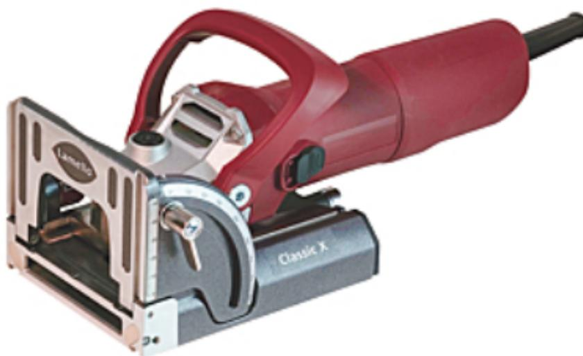
Le nom Lamello correspond au nom du fabricant inventeur de ce type d'assemblage. Cette machine est pourtant bien une rainureuse.
