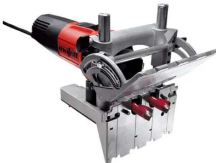
Plus rarement il existe des portatives qui utilisent le système des tourillons. Le tourillon positionne les pièces de bois à assembler dans les 3 dimensions sans jeu de fonctionnement, ce qui est un avantage pour un travail rapide et précis. Cette machine peut être utilisée aussi bien à l'atelier qu'en chantier.
