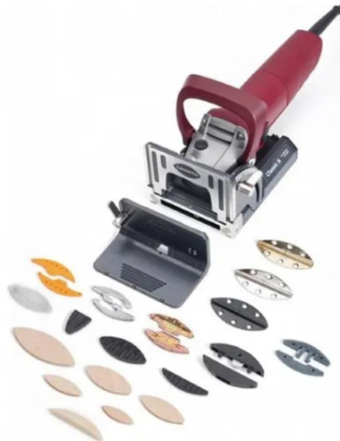
La rainureuse Clamex est conçue sur le même principe que la « Lamello ». Le maintien ne se fait plus par collage, mais par simple emboîtement coulissant.
