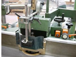
**La continuité de la pièce doit être assuré**, lorsque cela est possible, par un guide en bois ou en aluminium pour les faibles épaisseurs.
